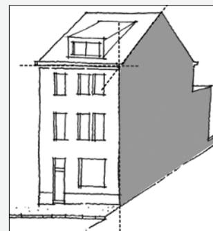
Fig. 6A : intersection du plan de façade et du plan de toiture – cas d'une construction avec toiture à versants.
