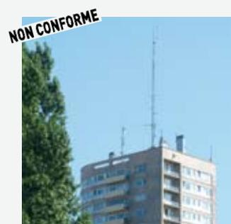
Fig. 10B : antenne de téléphonie mobile non conforme car dépassant de plus de 4 mètres la toiture de l'immeuble.
