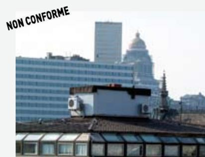
Fig. 10A : toiture non conforme : l'étage technique n'est pas intégré dans la toiture.
